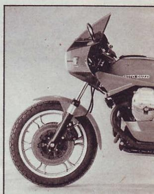
Viele Moto Guzzi-Anhänger waren von der Le Mans II enttäuscht. Kritisiert wurde vor allem die zweiteilige Verkleidung, bei der das Oberteil mitschwenkte, sowie Fahrwerkschwächen im oberen Geschwindigkeitsbereich. Trotzdem verkaufte sich das 204 km/h schnelle Motorrad in zwei Jahren 1366mal.
