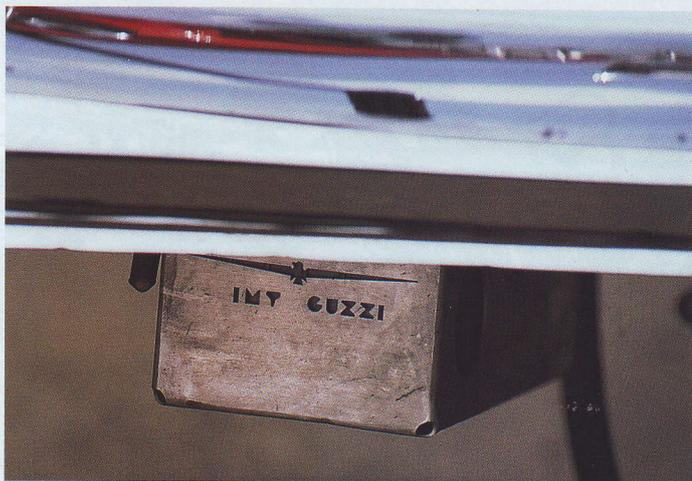
Ein maximal freies Rahmendreieck erfordert einen neuen Platz für die Batterie. Diesen gibt es zur Genüge unterhalb des Getriebes. Halterung aus Alu von IMT, darin eine Hawker-Gelbatterie mit 12 V/16 Ah
