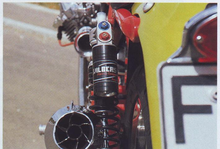
Wilbers Racing Suspension mit 2572 Einstellmöglichkeiten oder so. Hat man den Dreh mit den Schraubchen aber raus, ein Traum fürs Fahrwerk. Wahlweise mit oder ohne Ausgleichsbehälter erhältlich
