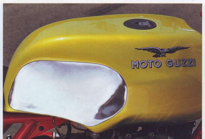
Orientierung an klassisch-britischen Vorbildern: Lackierung mit ausgesparter Fläche für das Fahrerknien. Der 25 Liter fassende GG-Alutank erfreut durch superbe Verarbeitung, kostet aber stolze 1600 Euro
