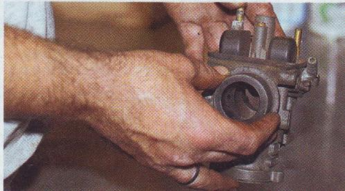
Die Liste der möglichen Störquellen am Vergaser ist lang: Verschleiß an Nadel, Nadeldüse und...
