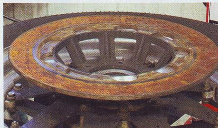
Die alten, flugrostanfälligen Grauguss-Bremsscheiben sind neu nicht mehr zu...
