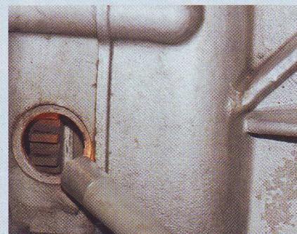
Der Blick durch die Kontrollbohrung: Wie steht es um den Anlasserzahnkranz?
