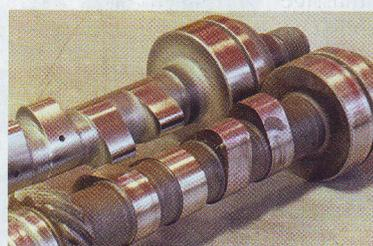
**Neue Nockenwelle:** plasmanitriert und mit Grundkreis-Bohrung
