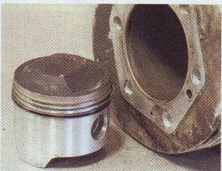
**Bei alten Zylindern** kann die Chromschicht abplatzen
