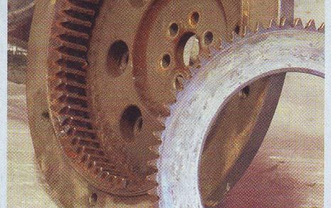
Defekte Verzahnung: Der Geräuschpegel steigt bei gezogener Kupplung
